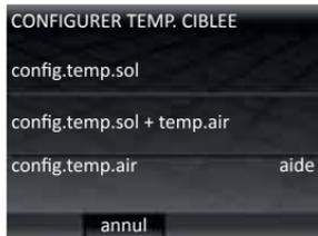
Pour réguler votre température de confort, vous pouvez utiliser une sonde au sol, une sonde air ou les deux.
