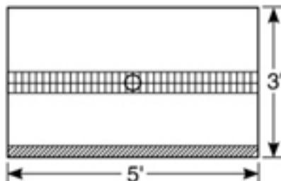
**Nota:** No exceda 3' del drenaje desde el bordillo o desde su drenaje a la pared. Las llanas flotantes Pre-Pitch STD-2011 son 3' de longitud y serán suficientes para la altura máxima de la base de cemento y arena y del bordillo.
